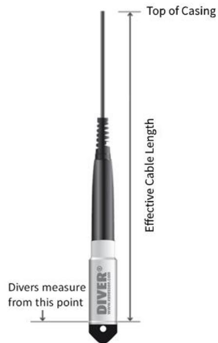
También se puede colocar la sonda mediante un cable de comunicación (n.º de pieza AS2xxx). Este cable permite leer los datos de la sonda colocada en la parte superior del pozo de supervisión con la ayuda de un Smart Interface Cable (n.º de pieza AS346).
